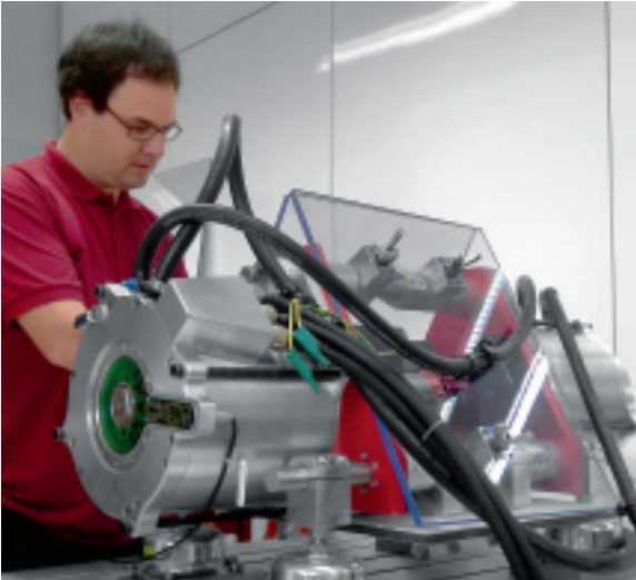
Die BRUSA Elektronik AG lieferte die hocheffiziente Leistungselektronik für den POLO REX – Testsituation auf dem E-Motorenprüfstand.
