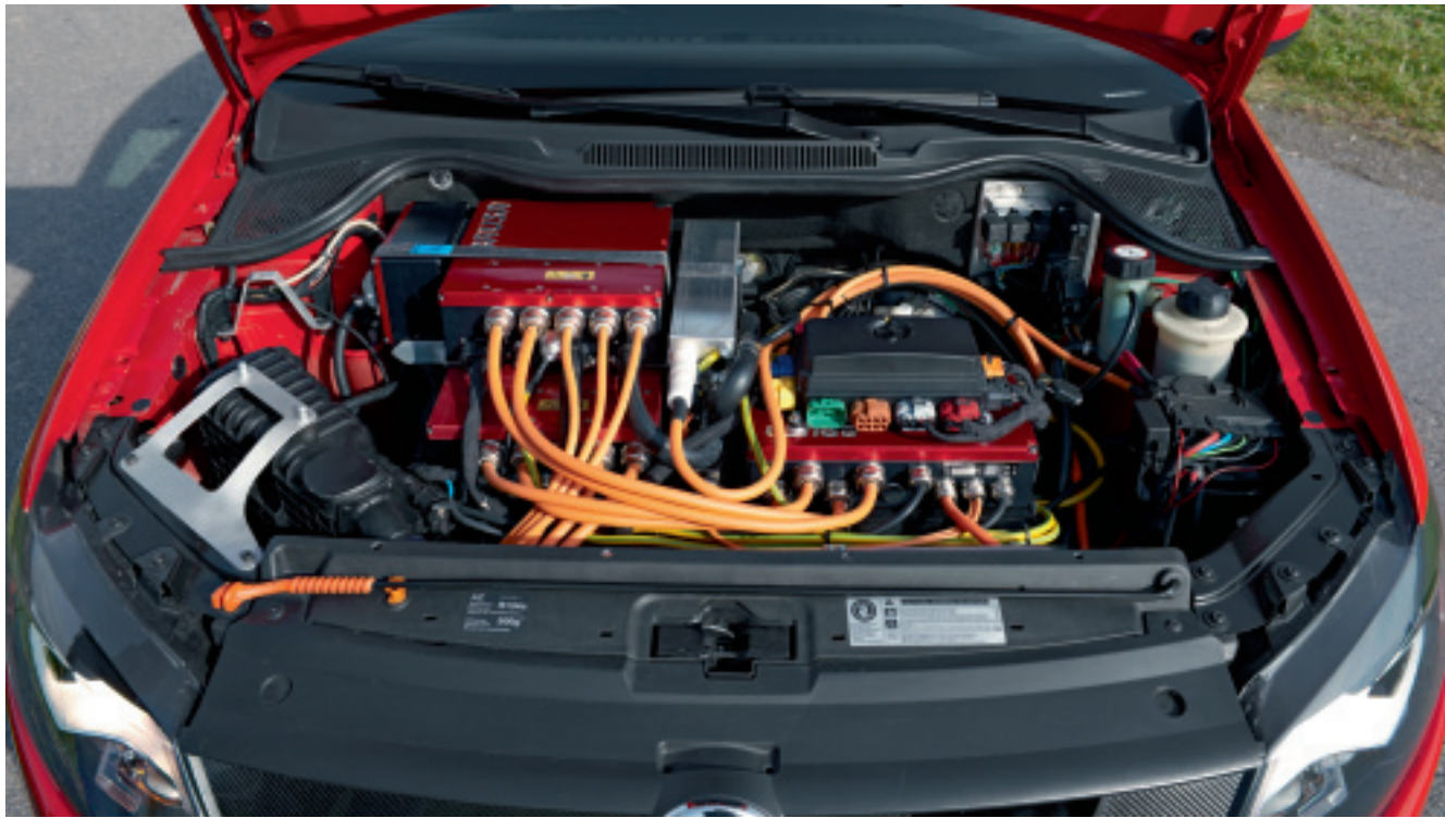
Der SWISSAUTO-POLO-REX-Motorraum mit Elektro-Motor, Leistungselektronik und dem genialen Range Extender. Schweizer Technologie, die weltweit bei den Automobilherstellern auf reges Interesse stösst.
